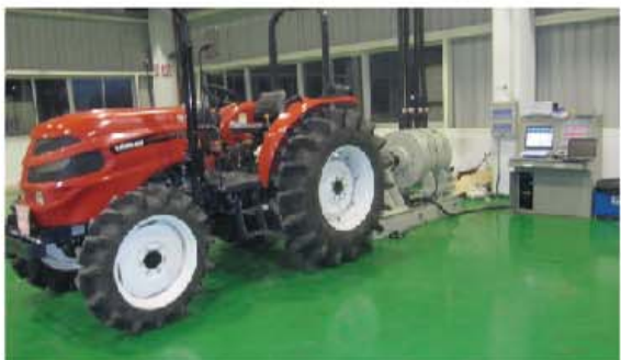
Wuxi Yanmar tractor PTO test bench 无锡洋马拖拉机PTO测试台
