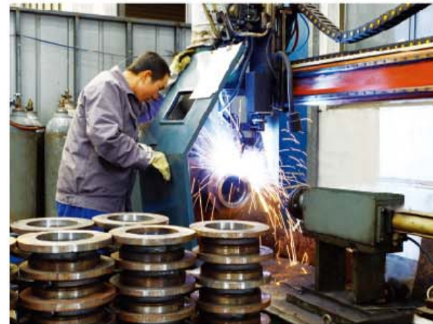
Panasonic automatic welding 松下自动焊接
