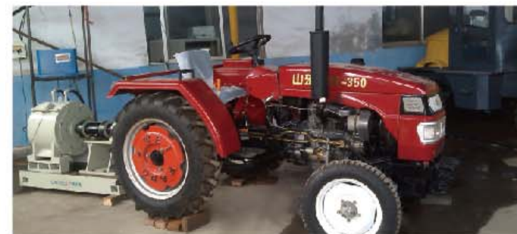
Shandong Zhongte tractor PTO test bench 山东中特拖拉机PTO测试台
