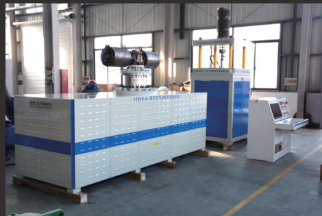
0~1000kN.m 直行程拨叉式执行器测试台 Straight stroke hydraulic actuator test bench
