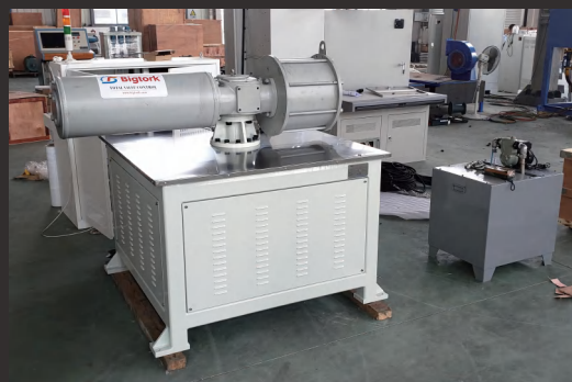
1~300kN.m 拨叉式气动执行器测试台 Fork type pneumatic actuator test bench
