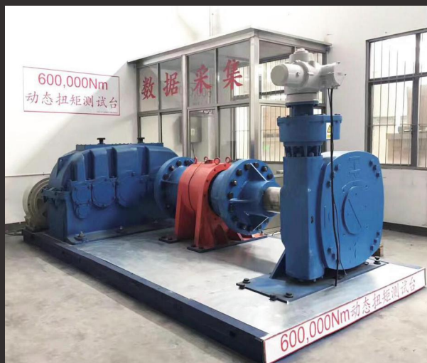
上海奇忠 600kN.m蜗轮箱测试台 Shanghai Qizhong 600kN.m Worm Gear Box Test Bench
